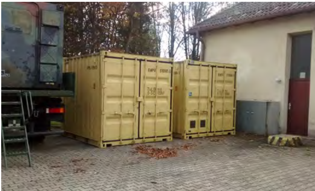
Aufstellung der Behälter zwischen Gebäude und Fahrzeug ohne ausreichenden Sicherheitsabstand
